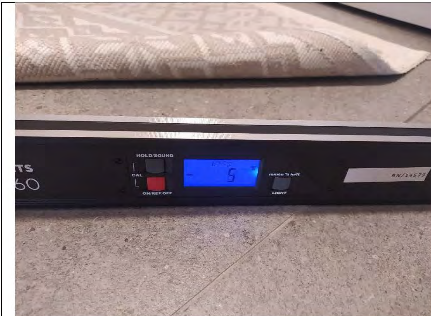
Фото №22. Измерение уровня напольного покрытия в ванной комнате (керамическая плитка).
