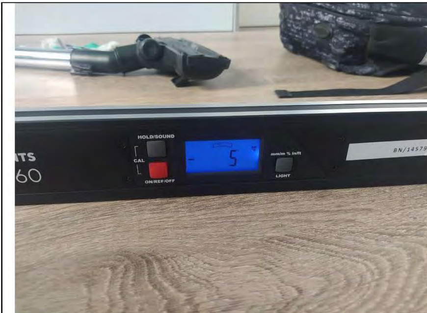
Фото №19. Измерение уровня напольного покрытия в детской.
