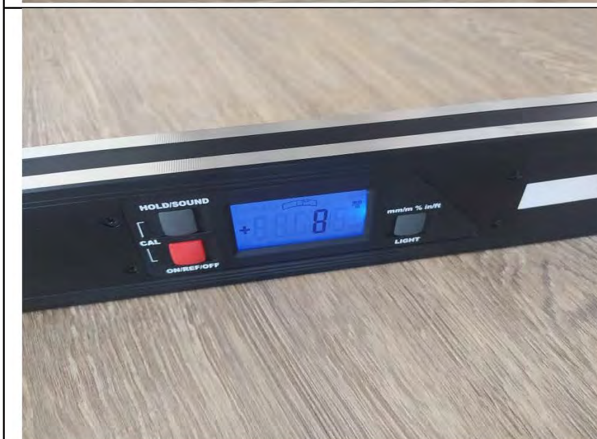
Фото №18. Измерение уровня напольного покрытия в гостиной.
