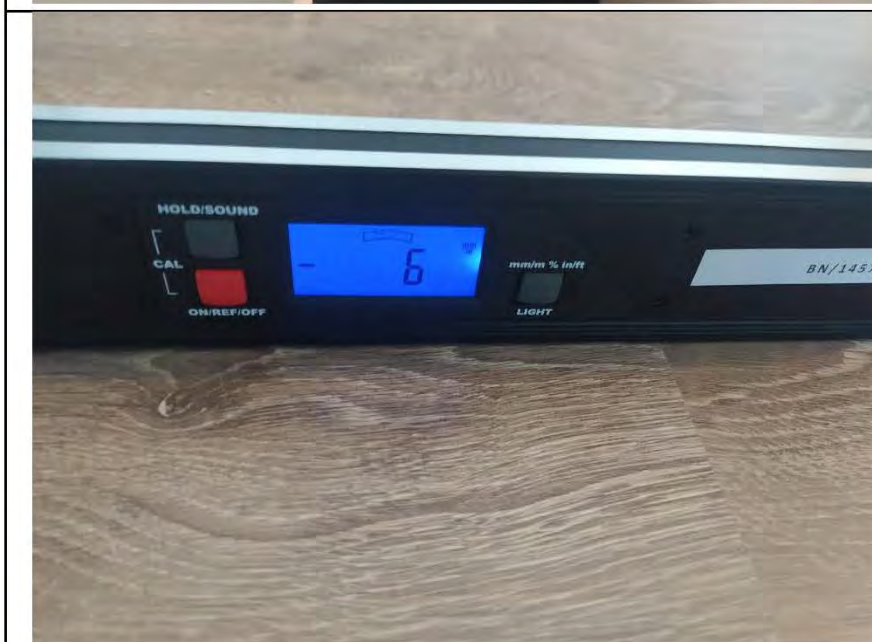
Фото №17. Измерение уровня напольного покрытия в спальне.
